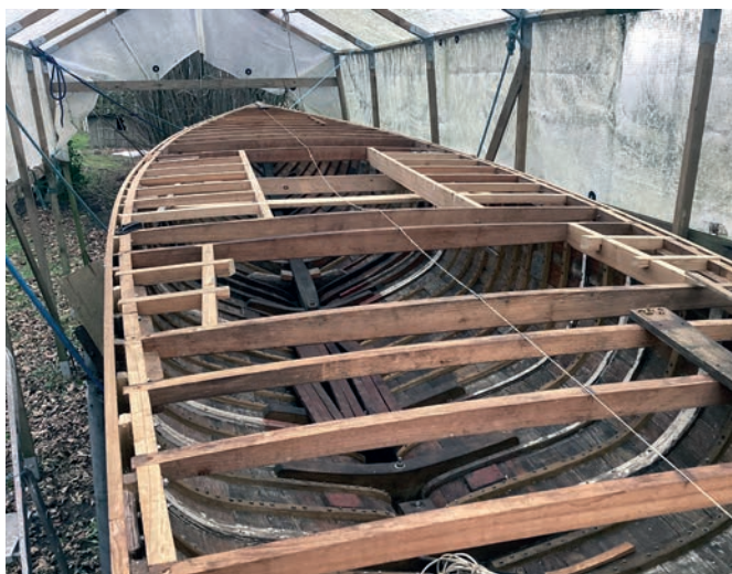
De sidste forberedelser før der lægges dæk
