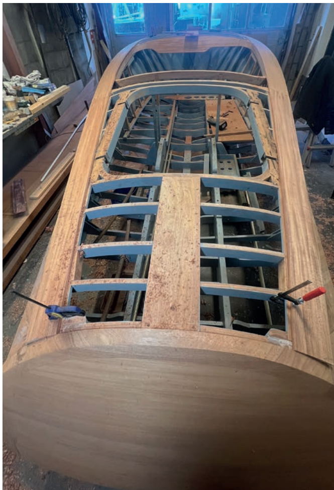
Agterspejlet og dækstrukturen er undervejs. Riva var kendt for deres "barrelback"
