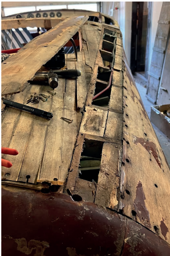
Meget træ er nedbrudt, men heldigvis er alle spanter undtaget 4 intakte og det strukturelle i orden.
