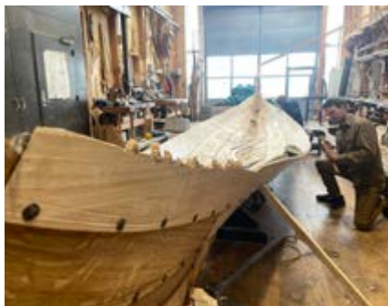
Martin og Bodo i gang med at sigte og hugge overkanten, så den bliver som vi vil have den: Jævn og fyldig, dér hvor båden skal bære mest. Foto Søren Nielsen
