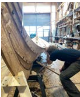
Martin og Bodo i gang med at sigte og hugge overkanten, så den bliver som vi vil have den: Jævn og fyldig, dér hvor båden skal bære mest. Foto Søren Nielsen
