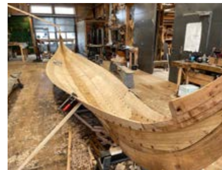
Martin og Bodo i gang med at sigte og hugge overkanten, så den bliver som vi vil have den: Jævn og fyldig, dér hvor båden skal bære mest. Foto Søren Nielsen
