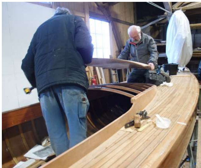
10/2 2022: Skallen til ruftaget lægges på plads...
