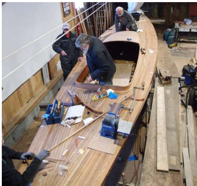
... og arbejde med dækfuger pågår.
