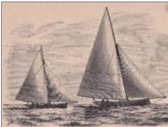
Båden til venstre viser bermudariggen med toppen ført løst over godset, Båden til højre fører den såkaldte gunterrig skriver Victor Hansen. Seilads og Roning 1893.
