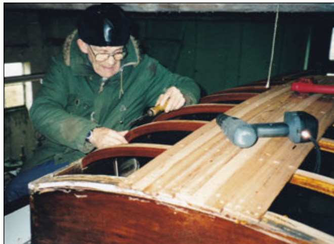
For neden: Somrene 1985 og 86 tilbragte Joane på land. Vi skiftede hovedspanter til rustfri stål, svejset sammen med bundstokkene, ligeledes af rustfrit stål. Kølplanken skiftet på nær de sidste 2,5 meter, desuden skiftede vi en del bundstokke, 57 svøb, alle bord under vandlinjen, lidt bord i hæk og stævn og 2 meter af skandækket i begge sider. Lige siden har vi haft en tæt båd.
