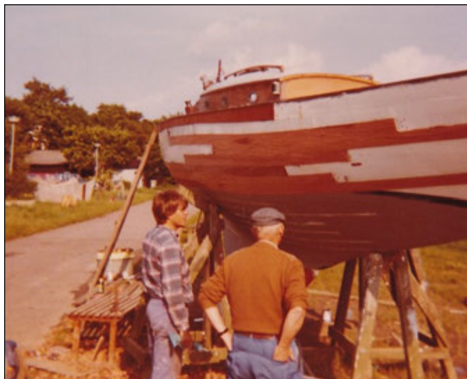
1981: I styrbordside var 10 svøb knækket, de blev skiftet sammen med en del bord.
