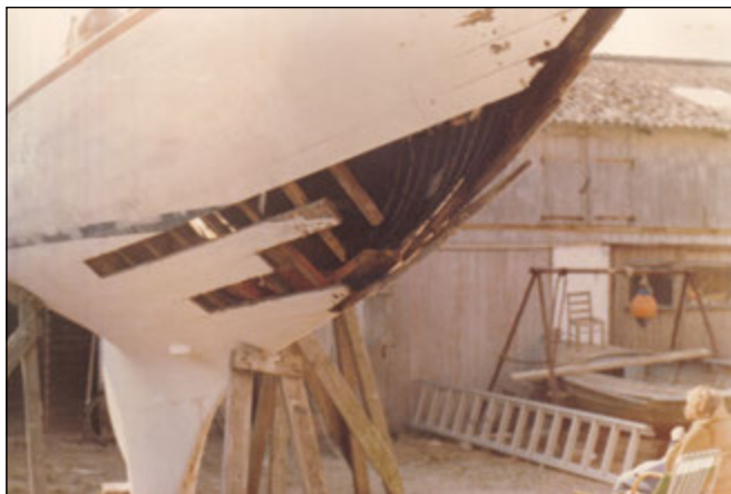
1979: Den første større reparation, ny stævn, 4 bundstokke, 7 svøb og lidt bord.
