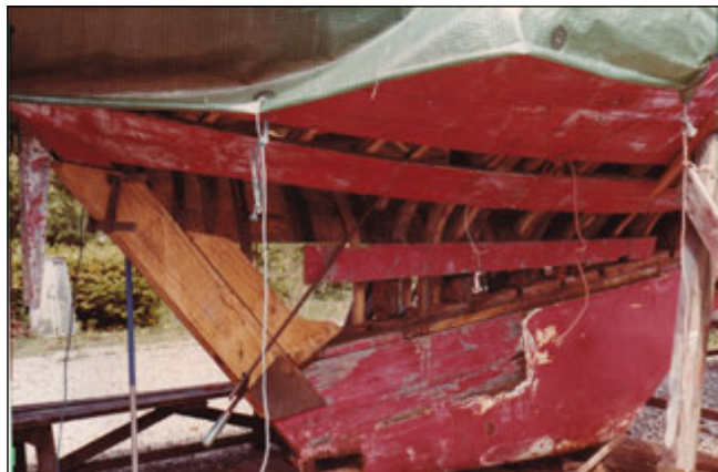
Nederst 2003 t.h.: Skroget fræset i alle nådder, og lister blev limet i med epoxy. Det var 21 lange dage for Marie og mig.
