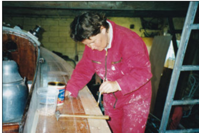
T.V. 1983: Stævnræ agter skiftes, samt lidt bundstokke og bord.
