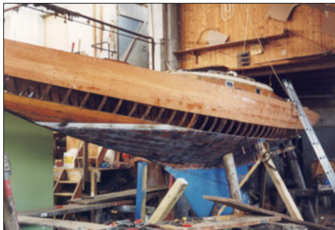
Fra Molichs bådhal. Klædningen er ved at blive skiftet. Den nye klædning limes i nådderne med PU-lim.
