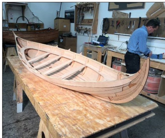
En prototype i 1:3 af Gislinge båden som samlesæt i krydsfinér. Foto: © Chesapeake Light Craft
