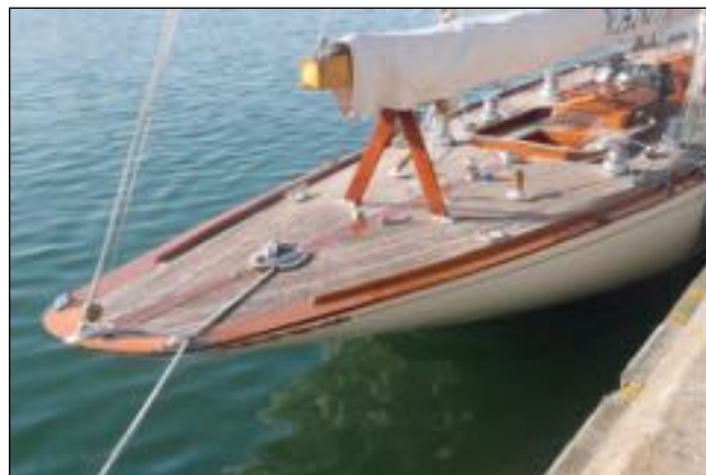
Flere VANITY V detaljer. Det var dette enorme overhang, der fordrede en flydestoksforlænger til NNL-måling ved SCR i 2006.
