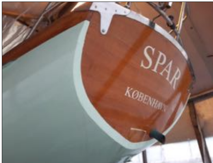
Store dele af agterskibet inklusive dele af agterspejlet måtte skiftes. Her fik Bo kyndig hjælp til det dobbeltkrumme agterspejl.
