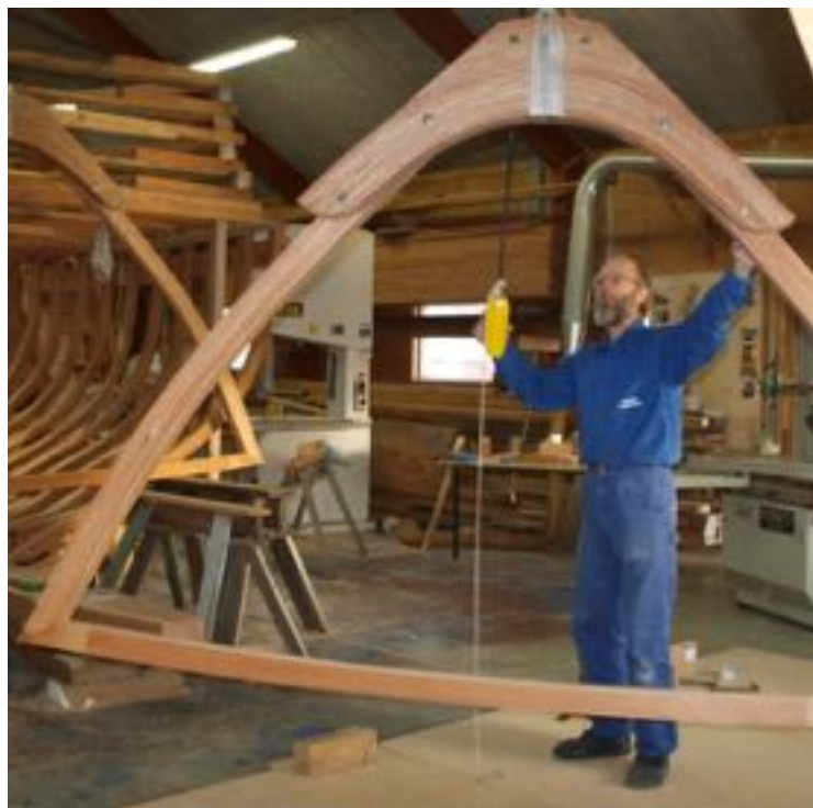
Finn Nielsen bygger spanter til en ketch - nybygning.
