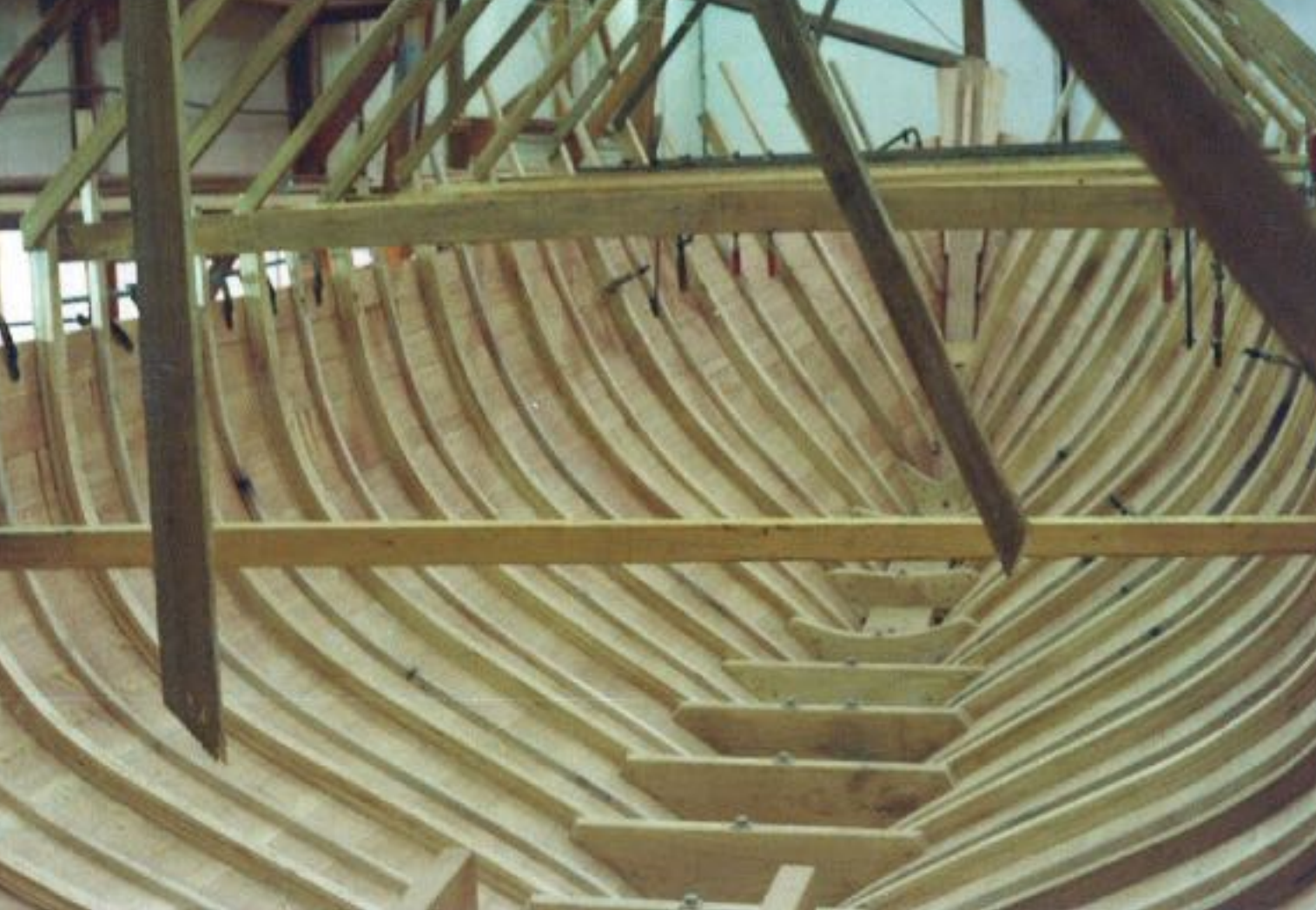
Skriventens egen båd, Strix, da den blev bygget i 1977. Laminerede spanter og herimellem dampbøjede svøb.
