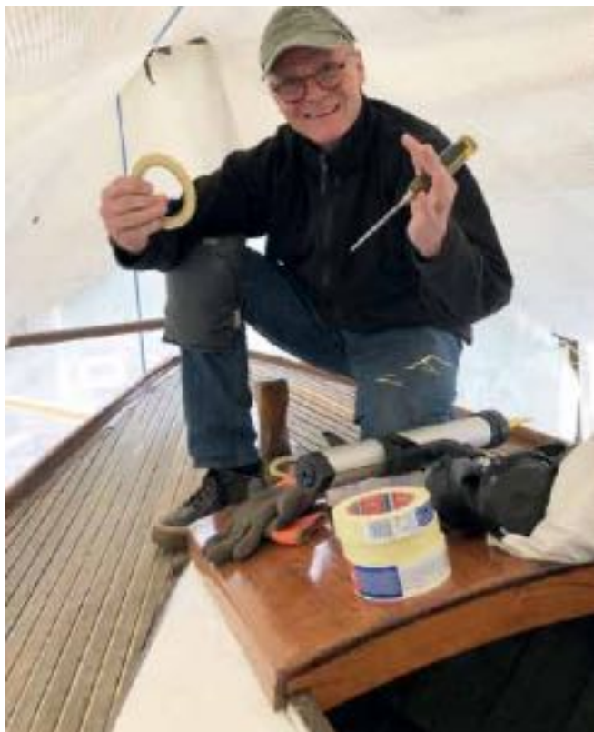
Nåddetape og affedtning skal give den gode vedhæftning
