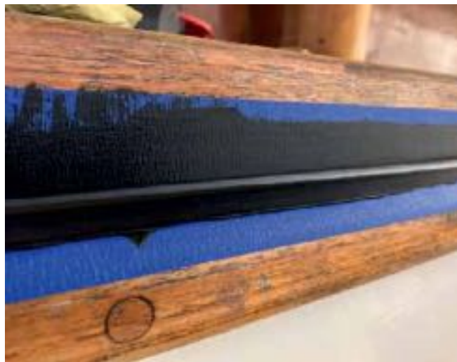
Malertapen sparer på teaktræet, når der skal renses i bund efterfølgende
