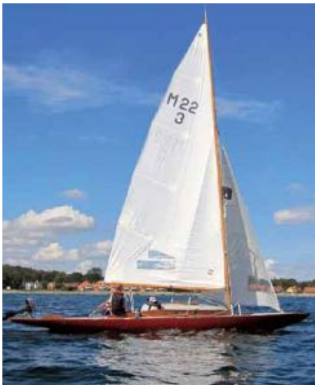
Træmasten opfører sig anderledes end en alumast ved kraftpåvirkning fra vinden. Det er vigtigt at sejlmageren tager højde for dette ved konstruktionen
