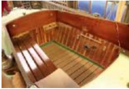
Utzons cockpitlayout med skrå karme under bænken står originalt
