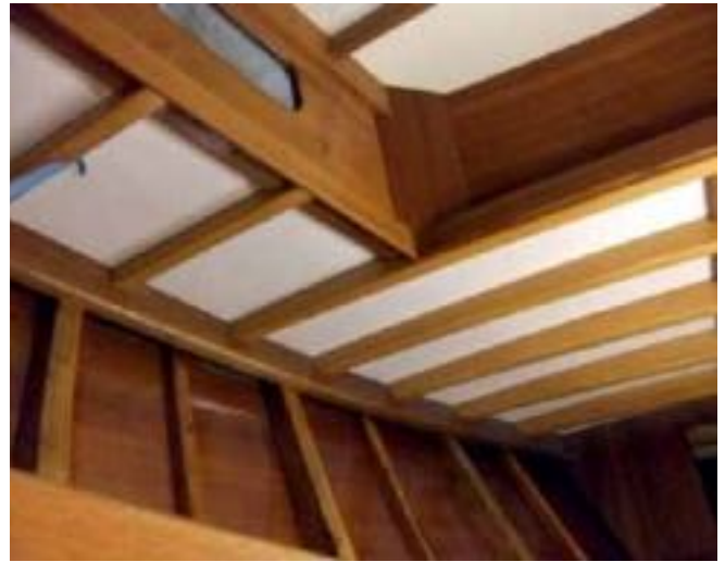
Klædningen fik blank lak – International "Schooner", og skot og kahyt en tilsvarende silkemat olielak
