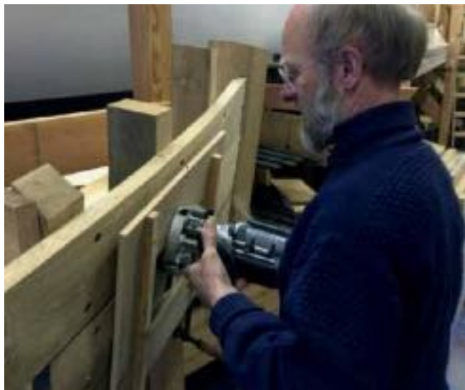
At anlægge et land til overfræseren er et delikat stykke arbejde. Spant rettes af til glat flade før ny planke indmåles. Foto: Anja Kiersgaard
