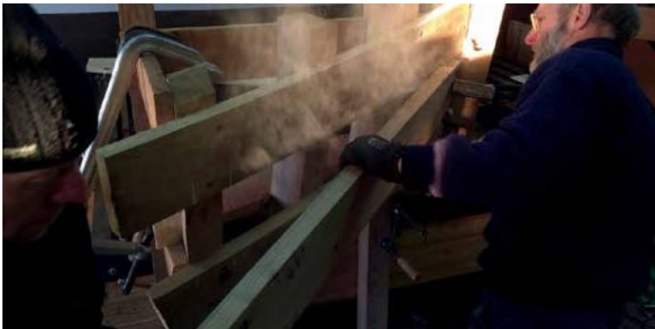
I røg og damp. Bådebyggeren tvinger dampet planke på plads. Foto: Anja Kiersgaard
