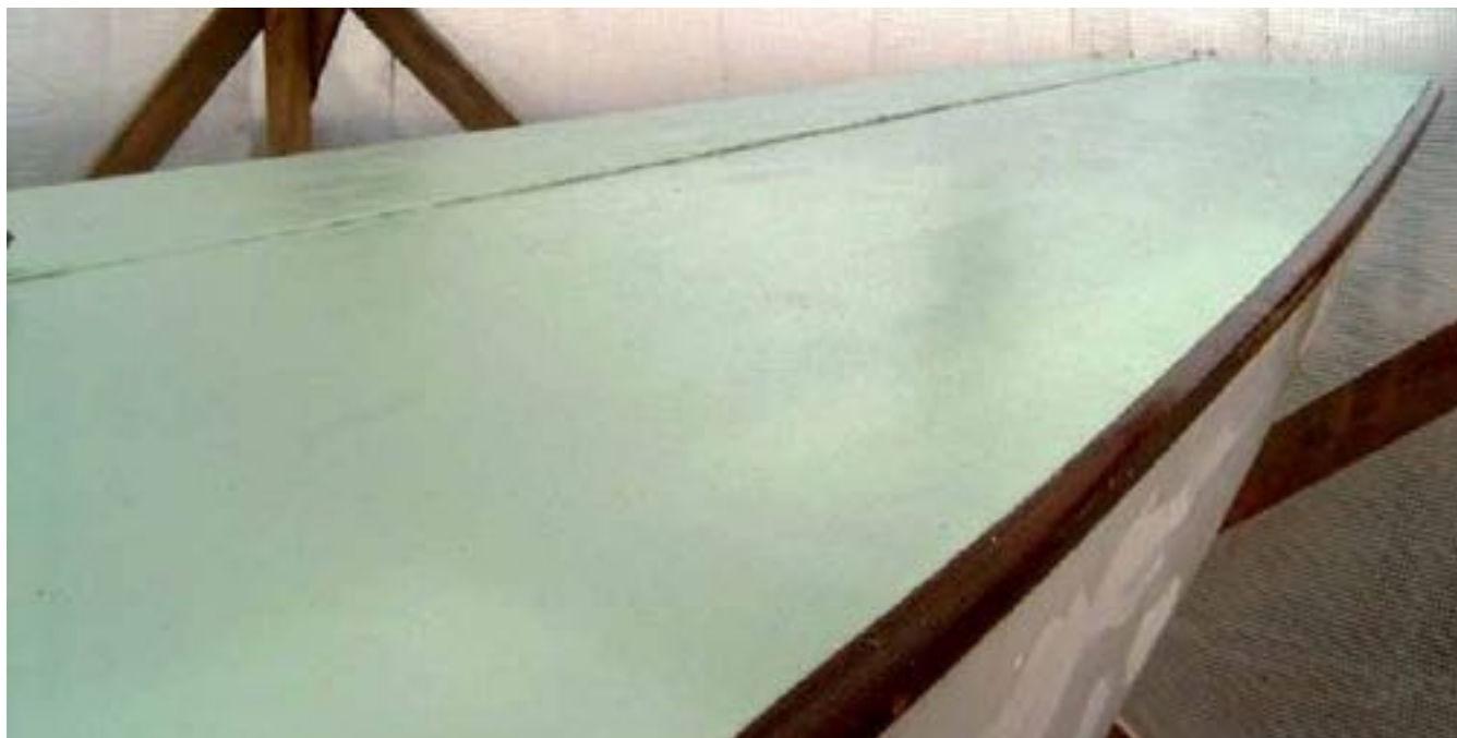
Saxon ny lærredsdæk blev imprægneret med linolie og malet med linoliemaling, den klassiske cromoxydgrønne.
