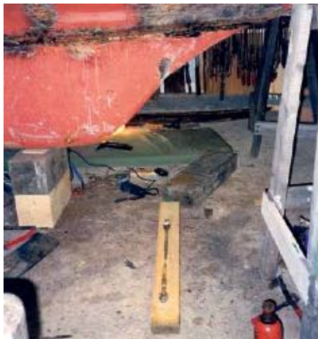
Udskiftningen af kølboltene var hårdt tiltrængt
