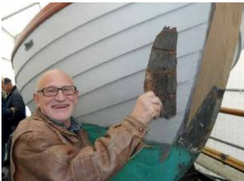
Peter har selv udbedret skaden, – ny stævn ! – Her viser Peter det gamle stykke stævnetræ.
