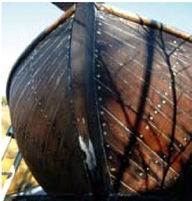
Hækken af en spidsgatter under restaurering – godt med linolie, uhhh...
