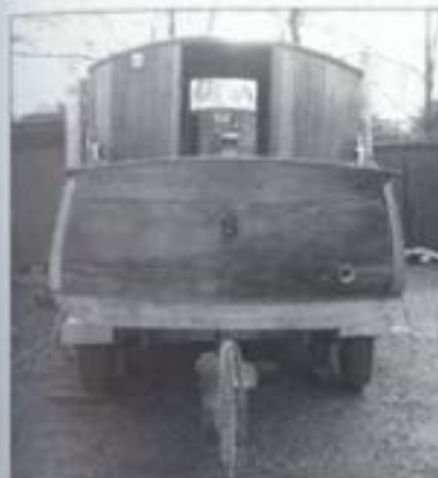
Triton er omkring 8,6 meter lang og 2 meter bred. Skroget er bygget i fyr på eg, overbygningen i fin mahogni.
