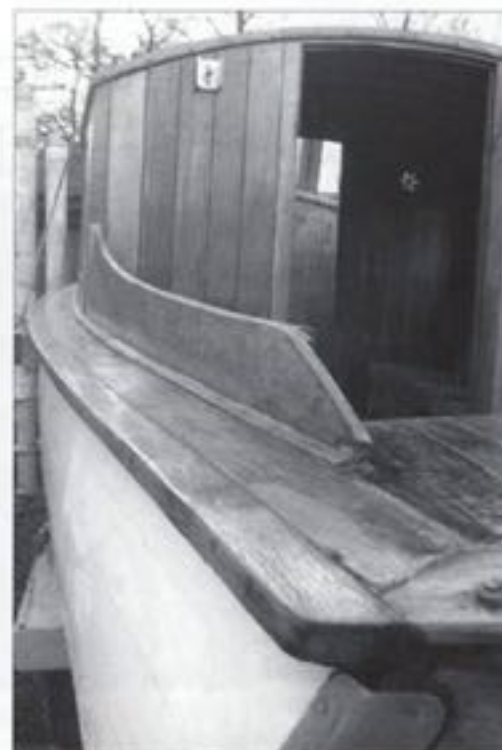
Triton er omkring 8,6 meter lang og 2 meter bred. Skroget er bygget i fyr på eg, overbygningen i fin mahogni.
