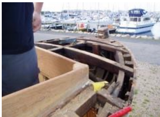
Dækket blev hevet af og udskiftet – og belagt med glasfiber
