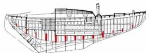
Bundstokkene forbinder kølen med spanterne og bærer ballastkølen
