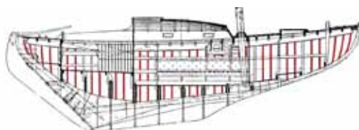
Svøbene anbringes mellem spanterne og holder sammen på klædningen
