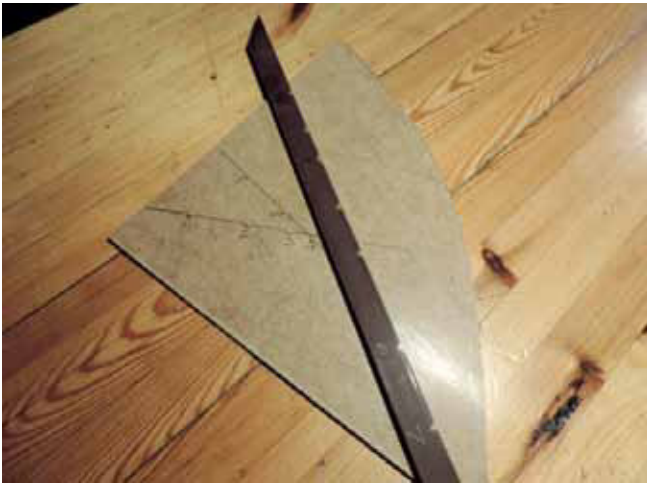
Sladrehanken er forsynet med hakker i forskellig afstand
