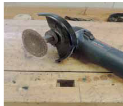
En vinkelsliber med en grov skrubske er også en glimrende hjælp til fin-tilpasning
