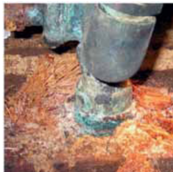
"Ludråd" ved skroggenemføring. Tydelig "pulled-pork"-effekt ved opløsning af bindemidlerne i træet
